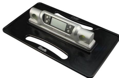
Figura 4. Aparato de medida oficial para controlar la inclinación de los sillines
