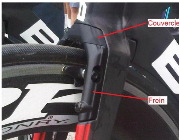
Figura 46. Freno integrado en la horquilla provisto de una cubierta
