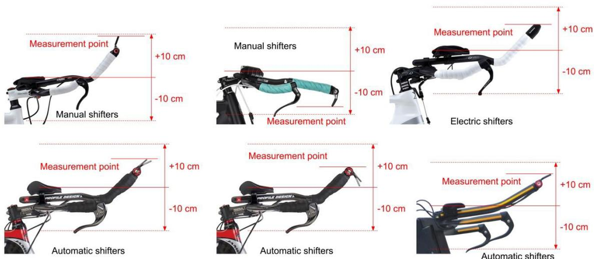
Figura 40. Puntos de medida de los límites verticales de los prolongadores con todos sus accesorios
