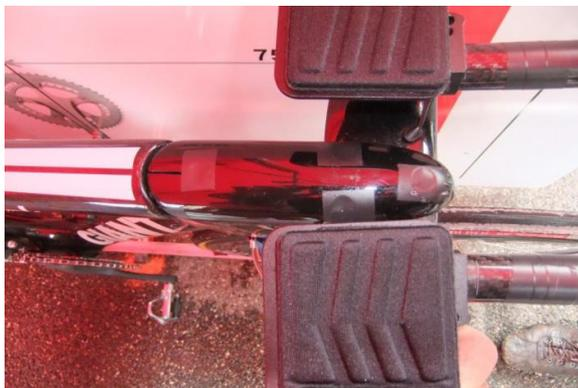
Figura 45. Ilustración de la tapa para cubrir el acceso al tornillo
